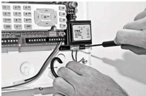
Fissare poi la guaina del cavo elettrico sul fondo del contenitore con l'apposita fascetta e la vite in dotazione. La messa a terra dell'impianto, oltre che preservare la sicurezza dell'utente, protegge le apparecchiature da sovratensioni o scariche atmosferiche che potrebbero danneggiare i circuiti elettronici della centrale.
