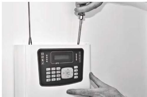
**LA CENTRALE AP16:** Gestisce complessivamente **18** zone così suddivise: **16** zone radio e **2** zone filari bilanciate programmabili per varie tipologie di funzionamento. È dotata della funzione tamper (antimanomissione) sia filare (di tipo bilanciato), che radio, per ogni singolo sensore memorizzato nel sistema.
