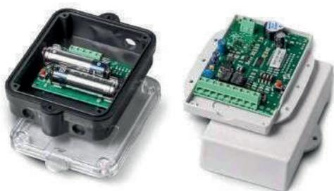
Il sistema Costa Radio è disponibile anche nella versione a doppia frequenza KITCRT433/868. Il sistema è composto da un trasmettitore multifrequenza TXCR433/868 e da un ricevitore multifrequenza RXCR433/868.
